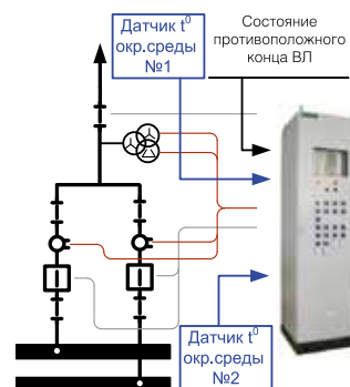
Условная схема подключения к присоединению с двумя выключателями (два ТТ) и шинными ТН
